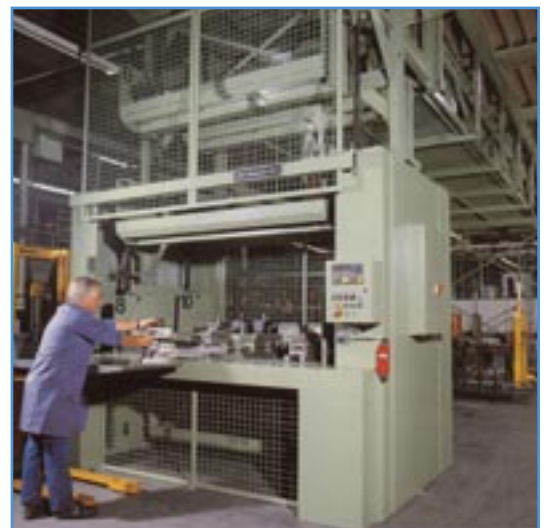
Brückenausführung mit freier Grundfläche
